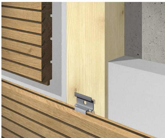
Detail horizontale Montage mit Montageclip
